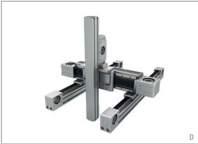
D - Unidades lineales: Eje X 2 E-SMART - Eje Y 1 R-SMART - Eje Z 1 S-SMART Elemento de conexión: 2 kit de abrazaderas de fijación para 2 R-SMART (eje Y) en 2 E-SMART (eje X). Placa de conexión para S-SMART (eje Z) en R-SMART (eje Y). Kit paralelo
